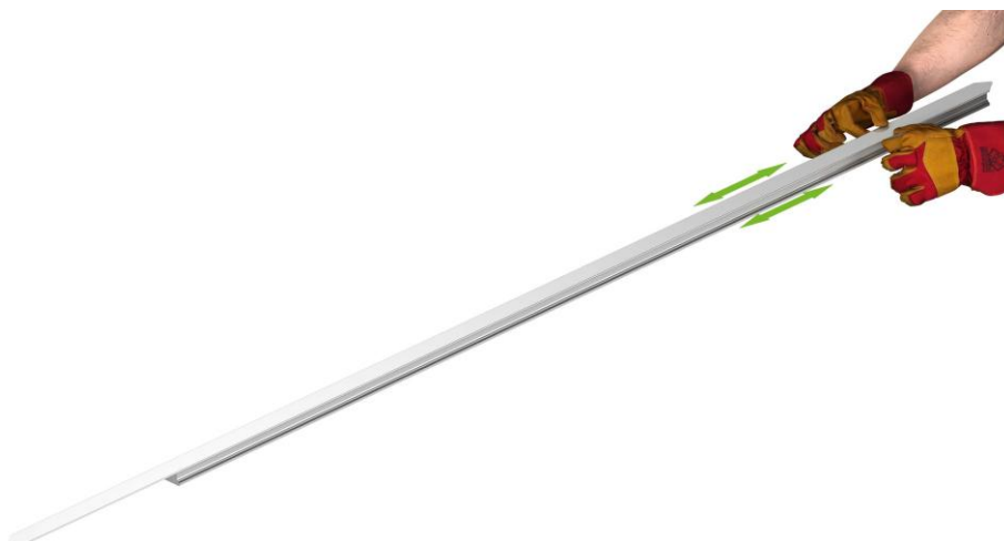
Obr. 5.28: Naklapnutí asi 3 cm krycího pásku
